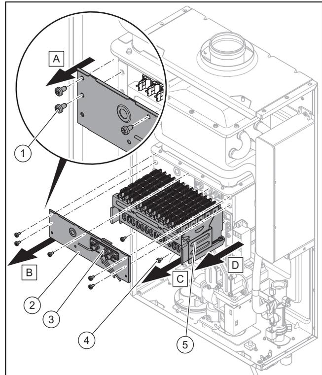
2. Retire los 5 tornillos (1) de la cubierta superior del quemador (2).
