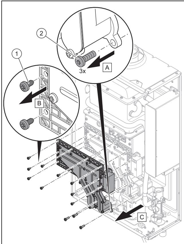
1. Retire los 3 tornillos (2) situados en la válvula de gas.
