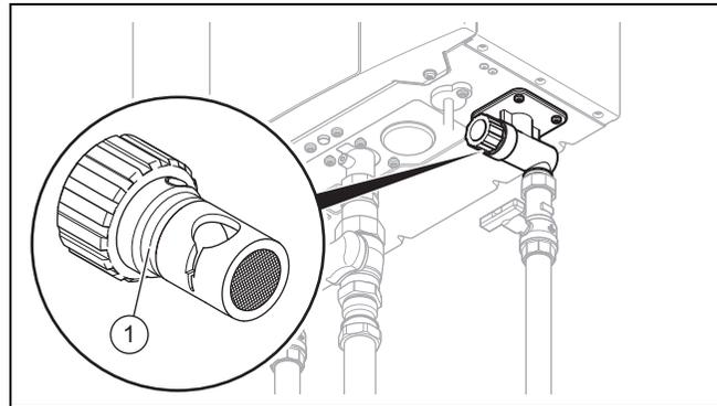
1. Retire el tamiz del filtro (1) situado en la conexión de agua fría.
