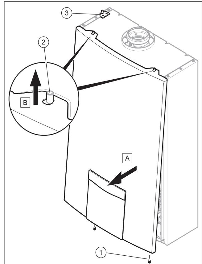
1. Retire los tornillos (1) situados en la parte inferior del producto.
