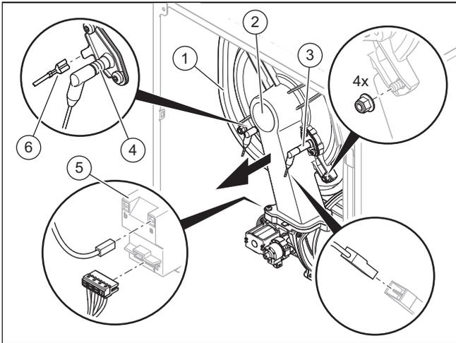
5. Extraiga el cable de toma de tierra (6) del electrodo de encendido (4), los dos conectores del transformador de encendido (5) y el conector del cable del electrodo de regulación (3).
