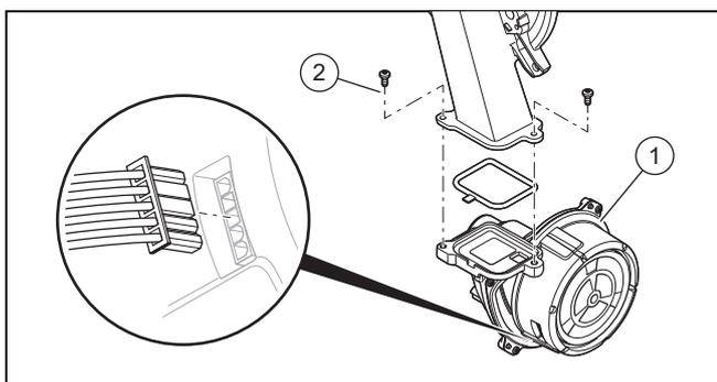
2. Extraiga el conector del motor del ventilador.
