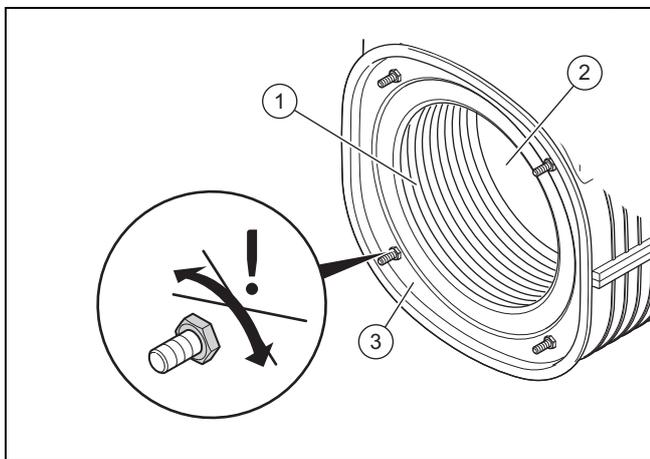
1. Limpie la espiral calentadora (1) del intercambiador de calor (3) con agua o, en caso necesario, con vinagre (acidez máx. 5%).
