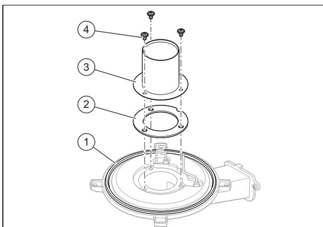
2. Desenrosque los cuatro tornillos (4) del quemador.
