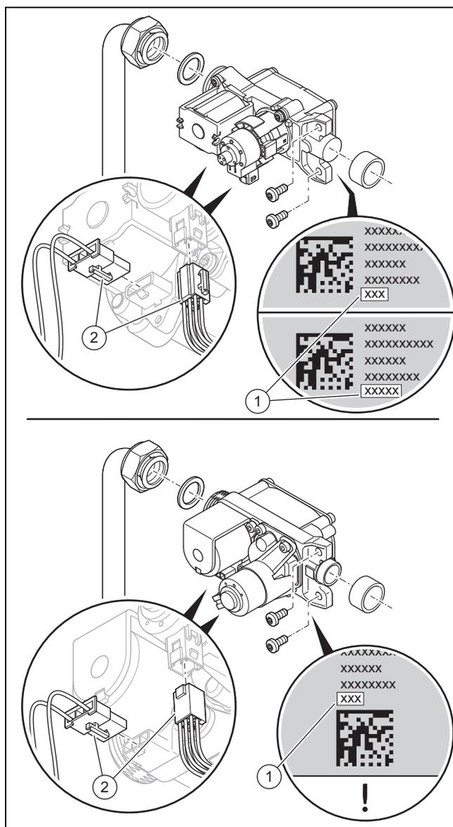
1. Extraiga los dos conectores (2) de la válvula de gas.
