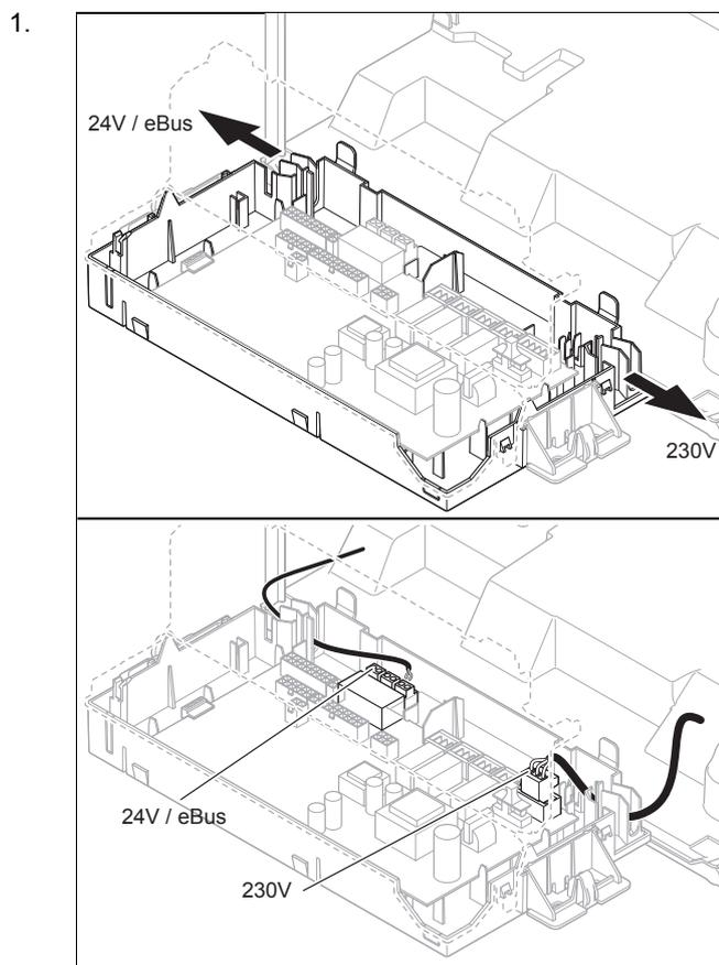
Tienda los cables de conexión de los componentes que se van a conectar por el pasacables situado a la izquierda de la parte inferior del aparato.
