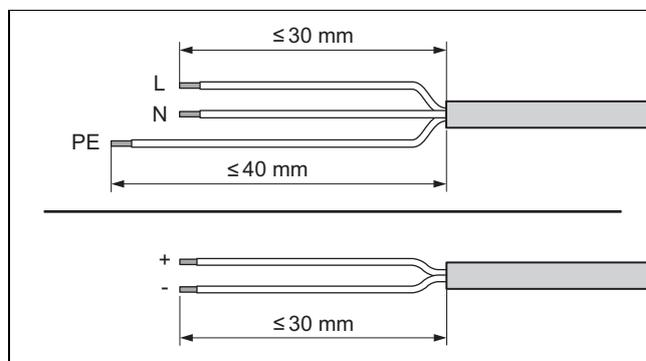
6. Pele los cables flexibles como se indica en la figura. Asegúrese de no dañar los aislamientos de los conductores individuales.
