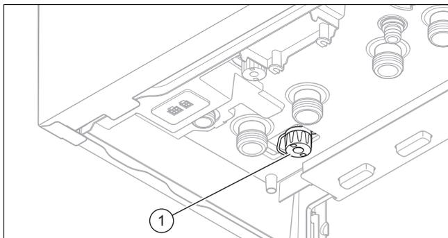
4. Conecte la llave de vaciado del circuito de calefacción (1) a la canalización.
