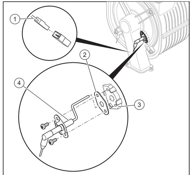
1. Extraiga el conector (1) del cable del electrodo de regulación.
