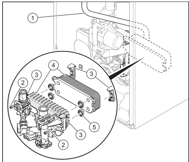
1. Retire las abrazaderas de la tubería de ida (1).
