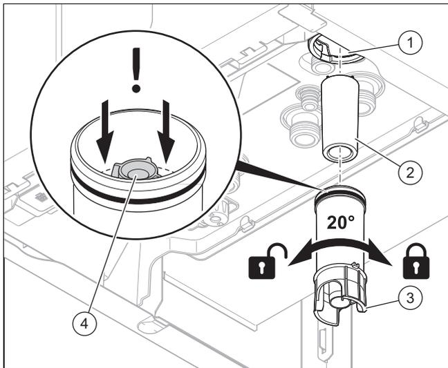
1. Afloje la parte inferior del sifón (3) de la parte superior (1).
