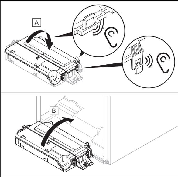
2. Procure que los soportes en el lado derecho e izquierdo de la caja de la electrónica estén correctamente montados.
