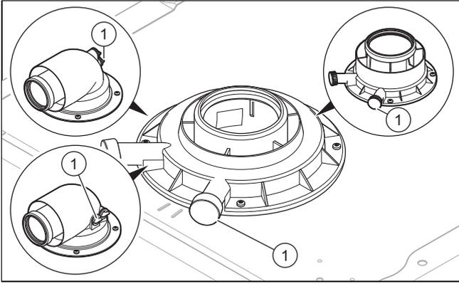
6. Mida el contenido de  $\text{CO}_2$  en la toma de análisis de gases de combustión (1) y registre el valor de medición.
