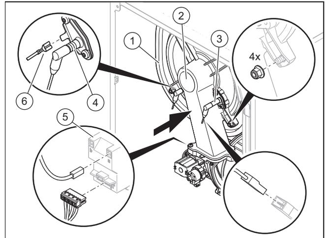
1. Inserte el módulo térmico compacto en el intercambiador de calor (1).
