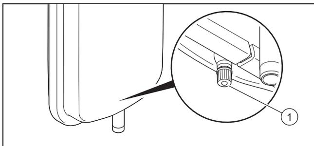
2. Compruebe la presión previa del vaso de expansión en la válvula (1) del vaso de expansión.
