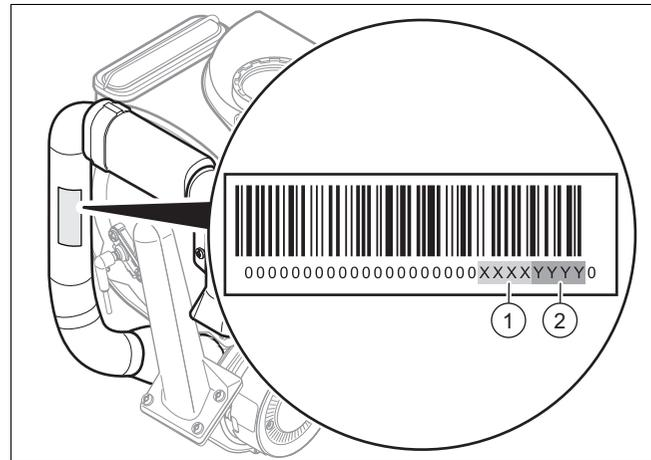
2. Observe el número de revoluciones mínimo (1) y máximo (2) en el tubo de aspiración de aire que figura en la placa de identificación.
