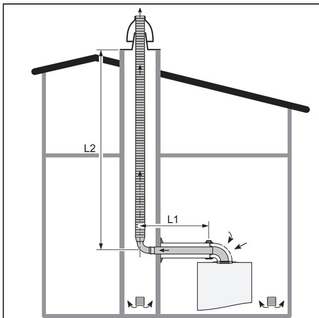
En esta configuración se puede utilizar una chimenea de gases de combustión o una chimenea de ventilación antiguas para montar un canal de evacuación para una caldera estanca.
