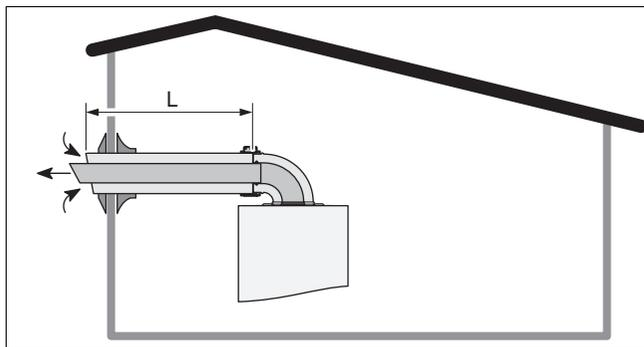
Longitud del conducto de toma de aire/evacuación de gases de combustión de tipo C13 (→ Página 34)
