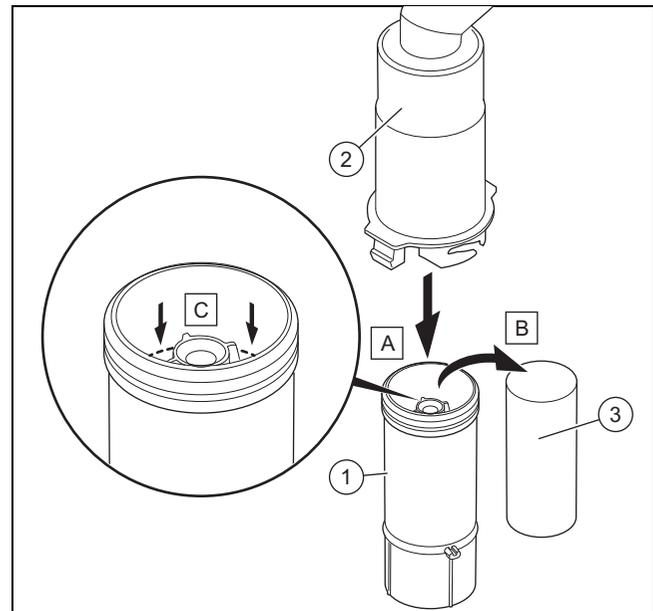
1. Desenganche la parte inferior del sifón (1) de la parte superior del sifón (2).
