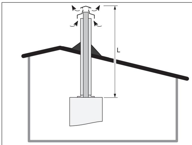
Longitud del conducto de toma de aire/evacuación de gases de combustión de tipo C33 (→ Página 34)
