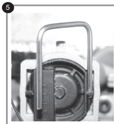
figura 27 - Extracción de la turbina del ACS
