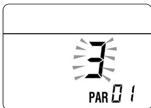
Cuando haya terminado la modificación de todos los parámetros deseados, para salir del menú de parámetros pulse **simultáneamente**, durante unos 5 segundos, las teclas **↩** y **||||** hasta que aparezca la pantalla inicial.
