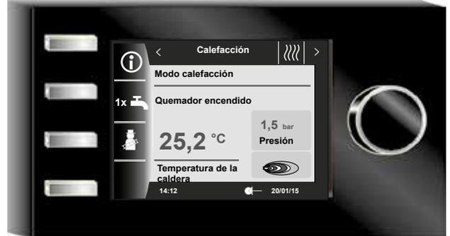
El BM-2 (unidad de mando) se comunica a través de e-Bus con todos los módulos de ampliación conectados y con el equipo de calefacción.
