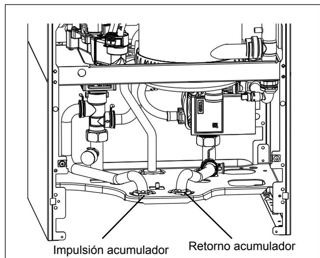
Figura: Bloque de conexión caldera con acumulador
