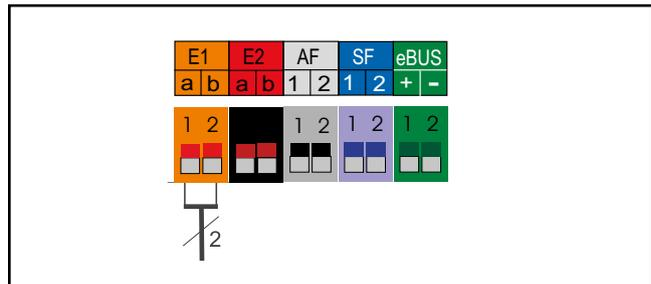
Figura: Conexión entrada E1
