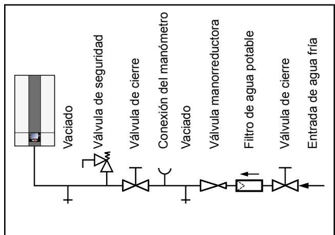
Figura: Conexión de agua fría según DIN 1988
