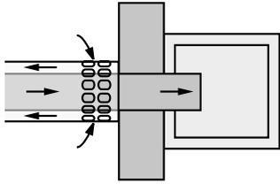
De acuerdo con la figura, la conexión a la chimenea de evacuación de obra con aberturas para aire ha de realizarse al borde de pasamuros para que el aire de combustión alcance todas las partes del tramo de evacuación.
