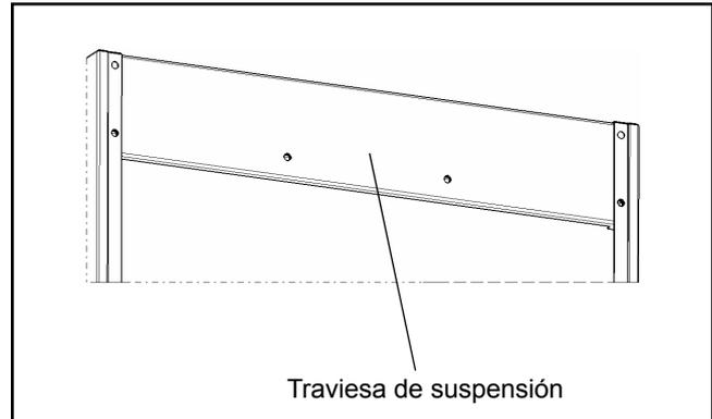
Figura: Travesía de suspensión en el aparato de condensación
