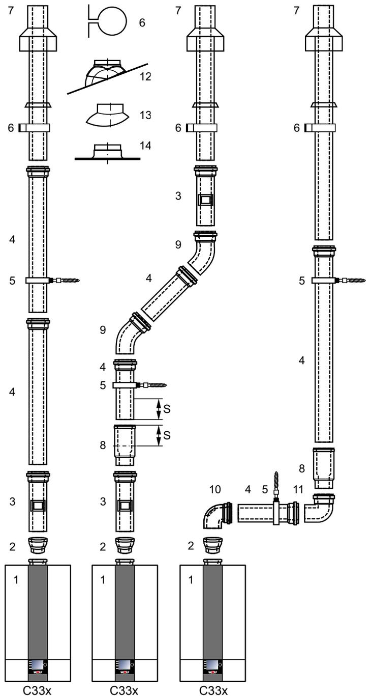
**Clase C33x:** equipo de condensación con conducto vertical concéntrico a través de tejado inclinado o tejado plano.
