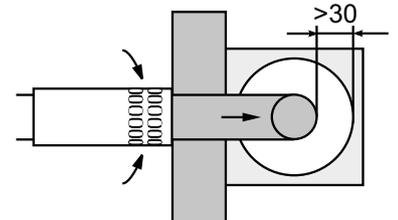
B33 dependiente del aire interior de la sala (sistema no estanco). Por el conducto DN80
