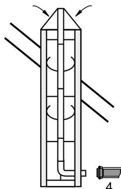
C93x independiente del aire interior sistema (sistema estanco) DN80/125 horizontal y DN80 vertical
