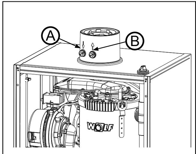
Figura: Medición del aire de aspiración y parámetros de gases de combustión
