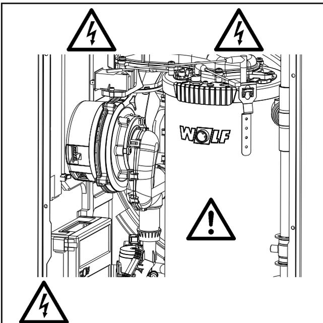
Figura: Transformador de ignición, electrodo de encendido de alta tensión, cámara de combustión
