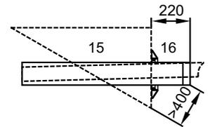
Montar el alargador de longitud ajustable (8) introduciéndolo en la embocadura de la pieza anterior hasta hacer tope.
