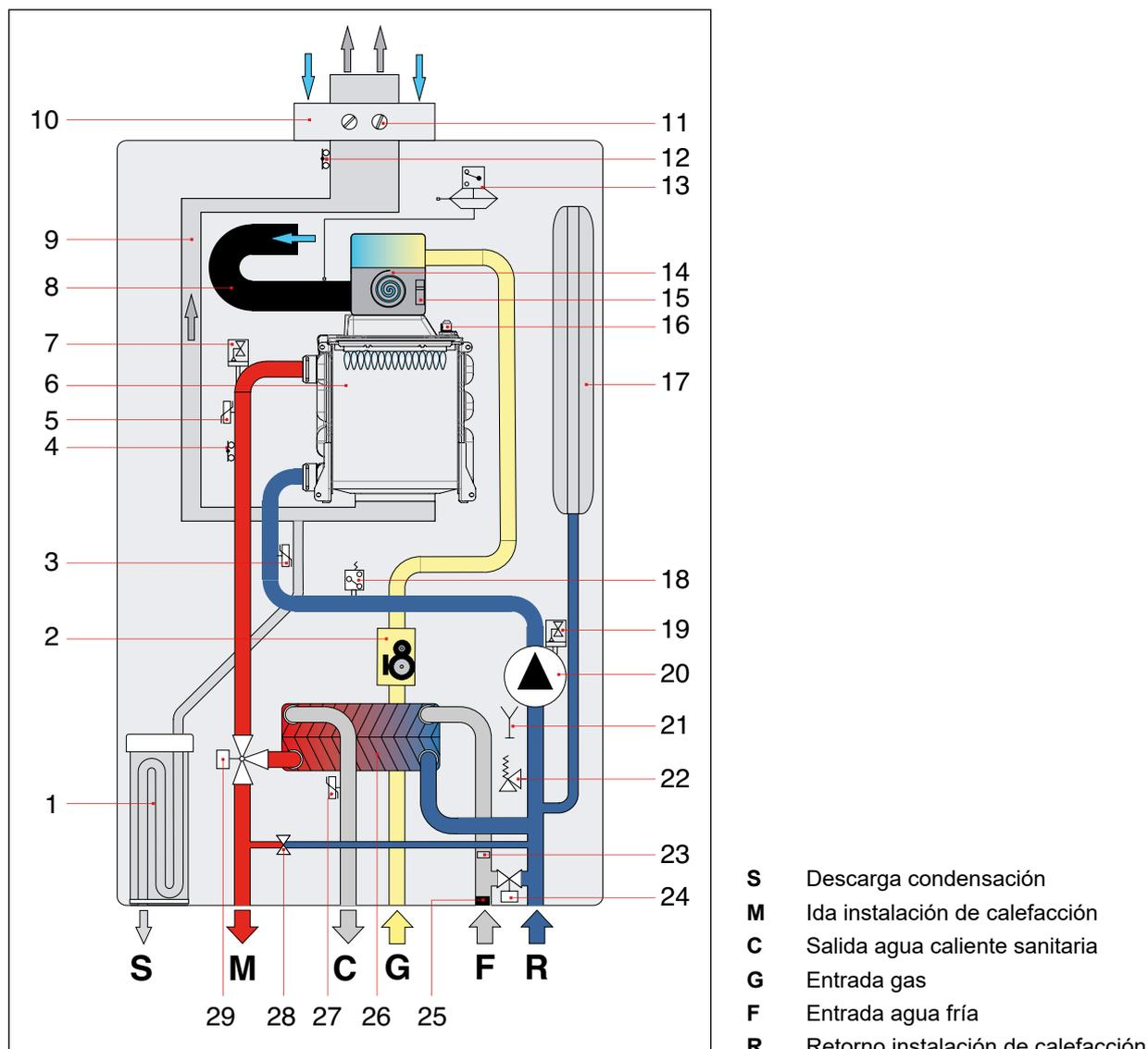
Fig. 5 Esquema hidráulico KC
