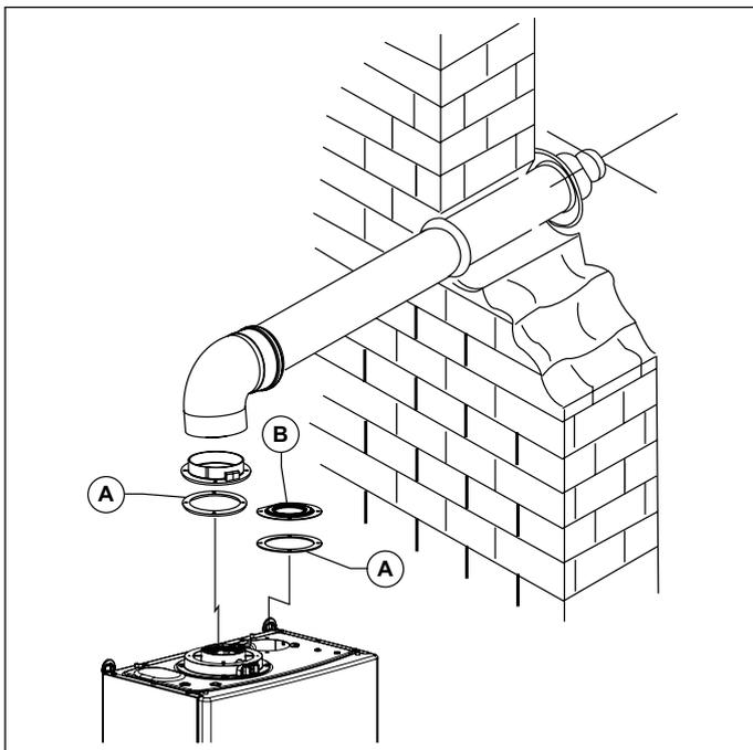
Fig. 16 Conductos coaxiales tipo C13 - C33
