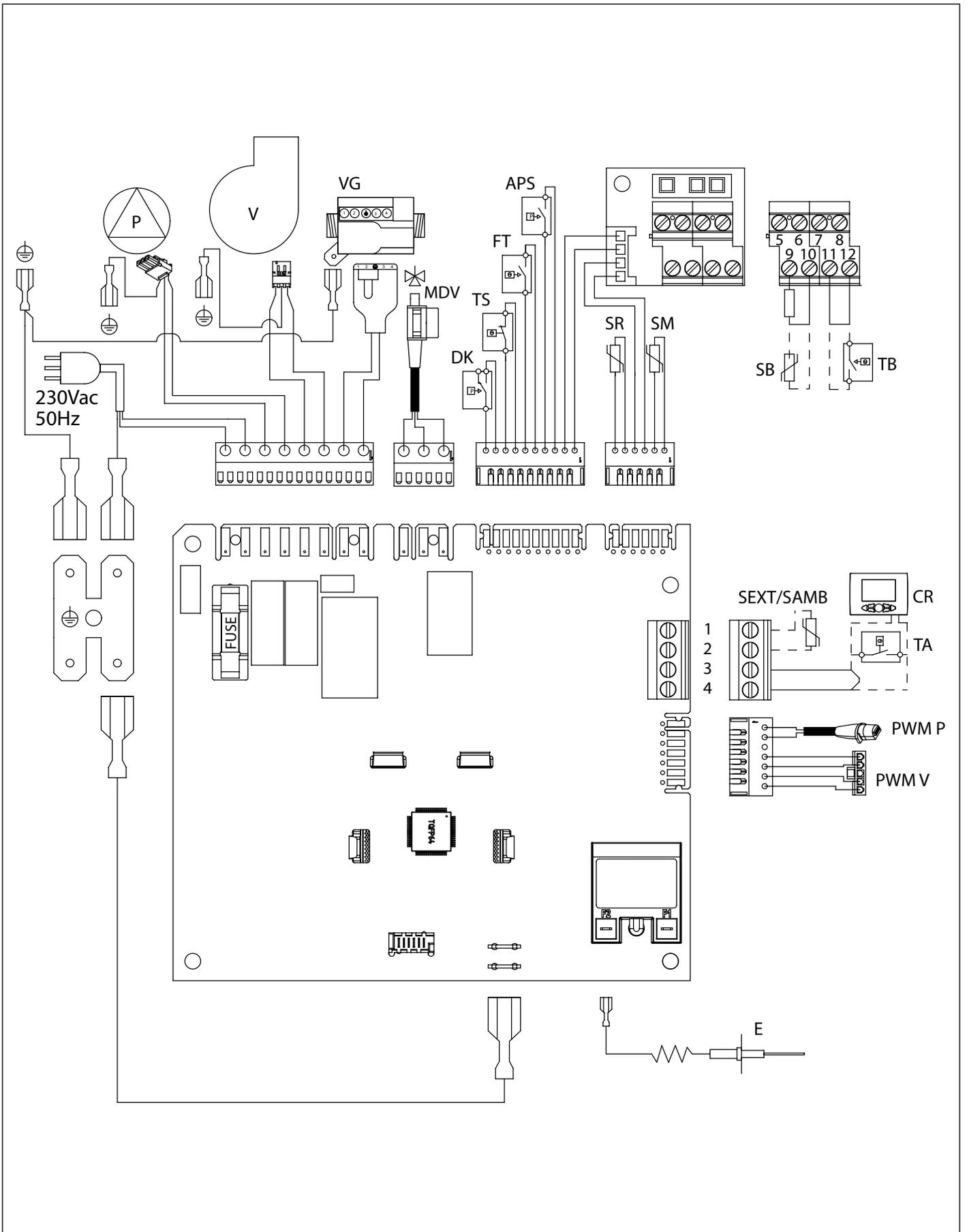
Fig. 28 Esquema eléctrico KRB
