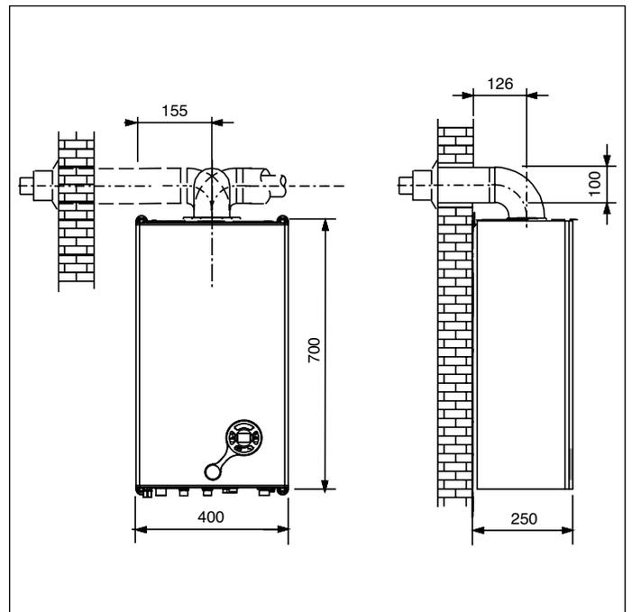
Fig. 17 Dimensiones conductos coaxiales tipo C13 - C33
