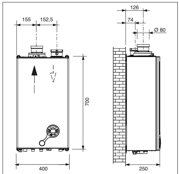
Fig. 19 Cotas dimensionales conductos desdoblados
