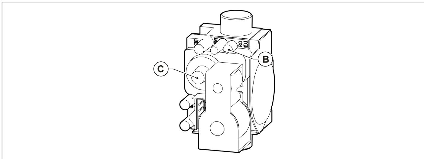
Fig. 30 Regulación valor anhídrido carbónico
