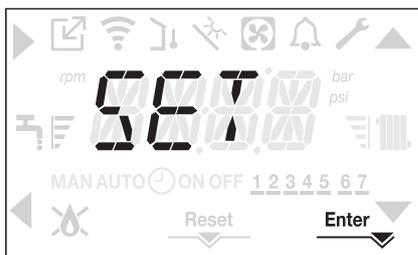
È ora possibile navigare all'interno del menu utilizzando i tasti freccia **C** e **D**, confermando l'accesso ad un sottomenu con il tasto freccia **B** A oppure tornando al livello precedente utilizzando il tasto freccia **B** Nota: il messaggio ERR sta ad indicare che la voce di menu od il parametro selezionati non sono disponibili per il modello di caldaia che si sta utilizzando.
