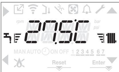
Sull'interfaccia viene normalmente visualizzata la temperatura di mandata a meno che non sia in corso una richiesta sanitaria, nel qual caso viene visualizzata la temperatura dell'acqua sanitaria.
