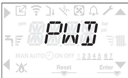
successivamente sui quattro digit appare <<0000>> lampeggiante con frequenza 0,5sec ON e 0,5sec OFF; le icone ▲, ▼, ▶ e ◀ si accendono per permettere l'inserimento del valore di password.
