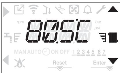
Tenendo premuto a lungo uno dei due tasti **C** oppure **D**, il contatore aumenterà la velocità di avanzamento modificando il valore impostato.
