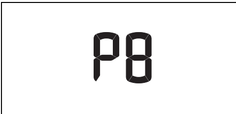
Fig. 12 P8 - Control de luminosidad
