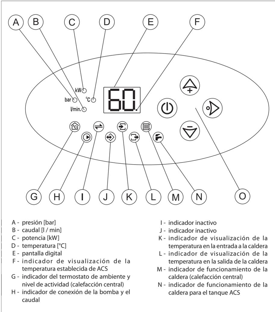
En el panel frontal hay dos áreas de trabajo, de señalización (A hasta N), y de control (O).
