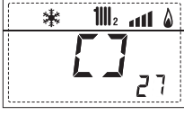
28. Visualización mando de apertura de la válvula con tarjeta ZONA MIX 2 (respectivamente ON y OFF)
