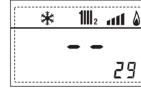
30. Visualización valor de la temperatura de la sonda solar S1 con tarjeta solar INSOL
