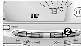
**2** - Los botones + y - a cada lado de
