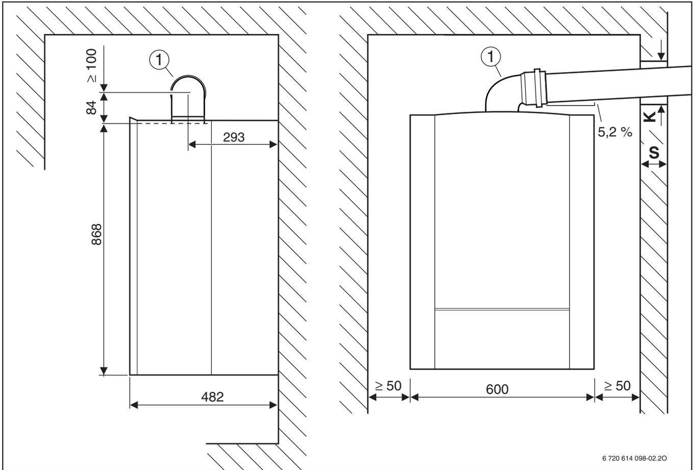
Fig. 6 Conducción de gases  $\varnothing$  60/100 mm
