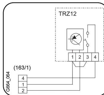
Fig. 8 - Conexión del cronotermostato. (Previamente eliminar puente entre 1 y 4, fig. 7, pos. 163/1)
