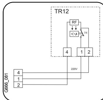
Fig. 7 - Conexión del termostato ambiente. (Previamente eliminar puente entre 1 y 4, fig 7, pos 163/1).
