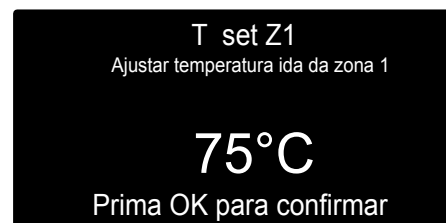
Modificação temperatura água quente aquecimento
